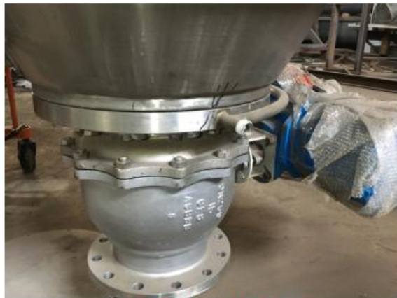
锥底氮气脉冲反吹装置
